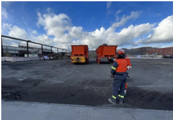
Hot Boxes an einer Kühlstelle. Eine Box wird zum Abkühlen abgestellt, während eine andere mit erstarrter Schlacke zur Kippvorrichtung gebracht wird.
